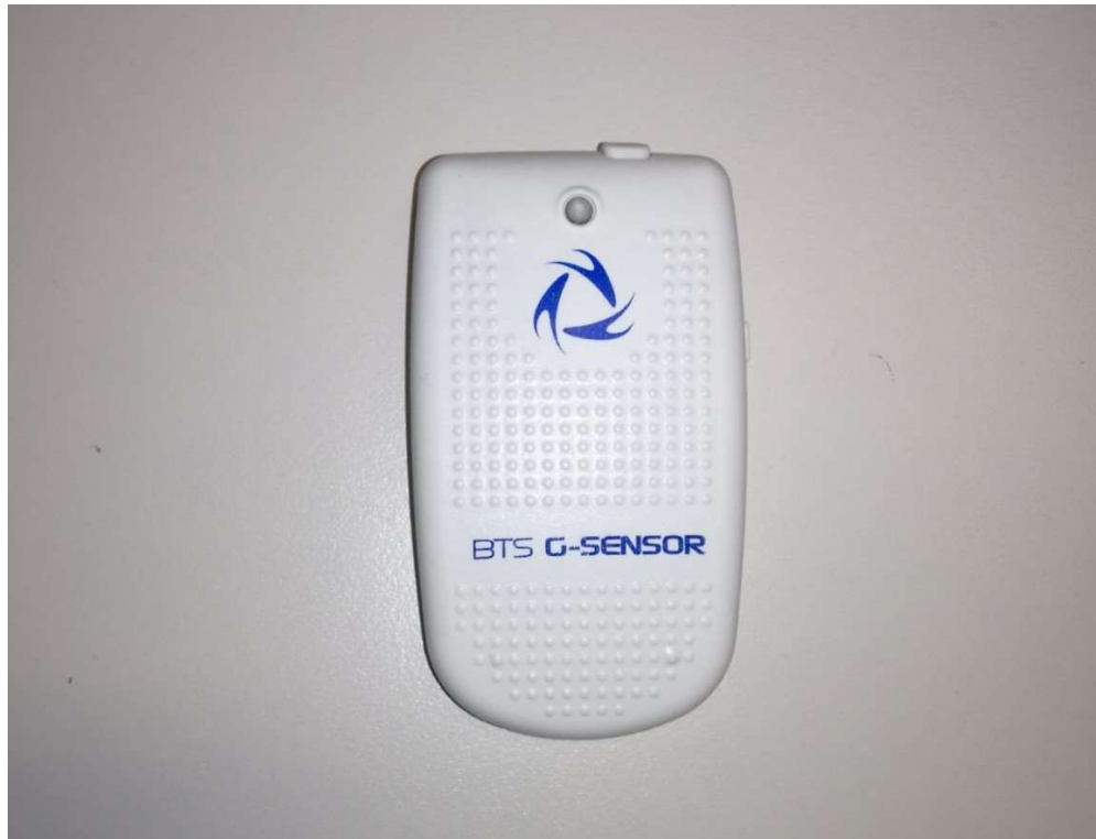
Figura 15: G-sensor prodotto della BTS Bioengineering utilizzato per svolgere la maggior parte dei test per l'analisi del movimento.
