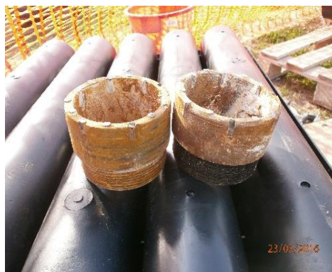
Figura 119 - Corone in widia utilizzate durante i sondaggi.
