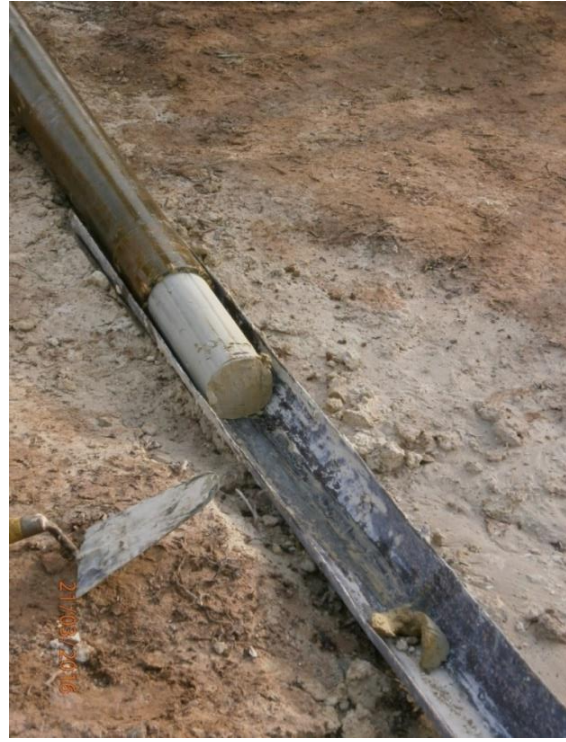
Figura 22 - Fase di estrazione del materiale dal tubo carotatore, a): si osserva il disturbo causato nella parte superficiale della carota dalle operazioni di carotaggio e l'alterazione della coesione del materiale generata dall'utilizzo dell'acqua. B): estrazione della carota mediante acqua in pressione. Si noti la sottile patina di rivestimento, nei primi millimetri superficiali, causata dall'attrito con le pareti del carotiere.
