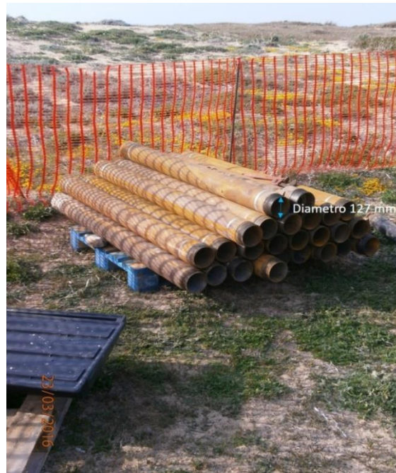
Figura 2112 - Tubi di rivestimento, al cui interno grazie al diametro di 127 mm tubi carotieri riuscivano ad operare.
