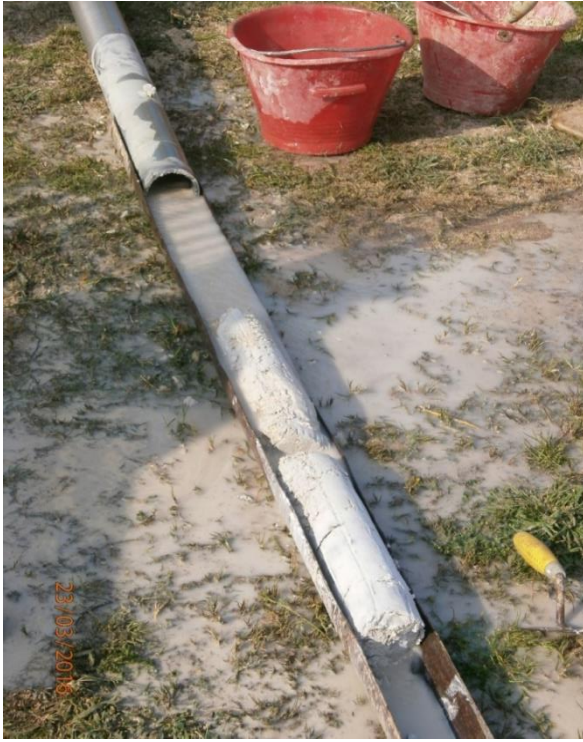
Figura 22 - Fase di estrazione del materiale dal tubo carotatore, a): si osserva il disturbo causato nella parte superficiale della carota dalle operazioni di carotaggio e l'alterazione della coesione del materiale generata dall'utilizzo dell'acqua. B): estrazione della carota mediante acqua in pressione. Si noti la sottile patina di rivestimento, nei primi millimetri superficiali, causata dall'attrito con le pareti del carotiere.
