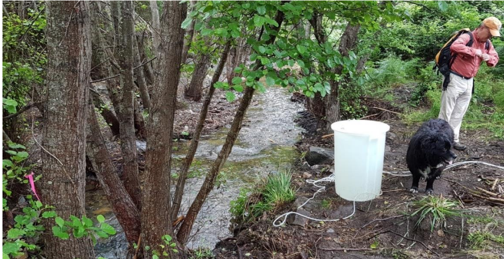
Figura 27 – Settore “T1” punto in cui è avvenuta l’injection in foto si può osservare anche la cisterna da 100 litri in cui è stato disciolto il NaBr.
